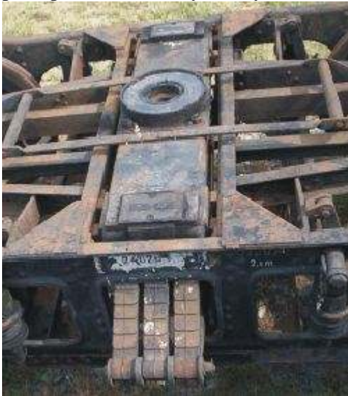
Vypružení listovými pružnicemi, jedno z původních řešení
