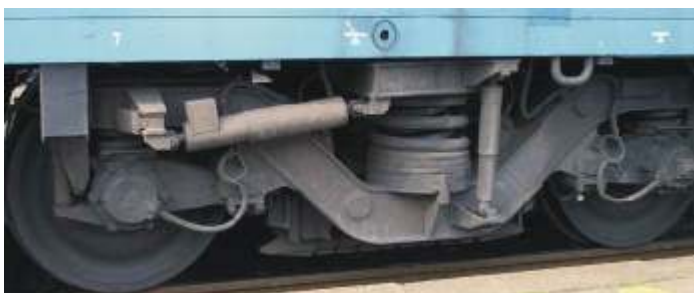
Obr. 1 Podvozek FIAT v uspořádání flexi – coil.
