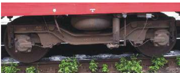
Obr. 2 Podvozek MSV 8-833 na vzdušném vaku.
